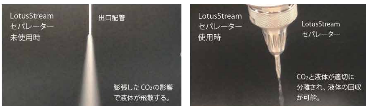
図 19 LotusStream使用時・未使用時の気液分離の様子
