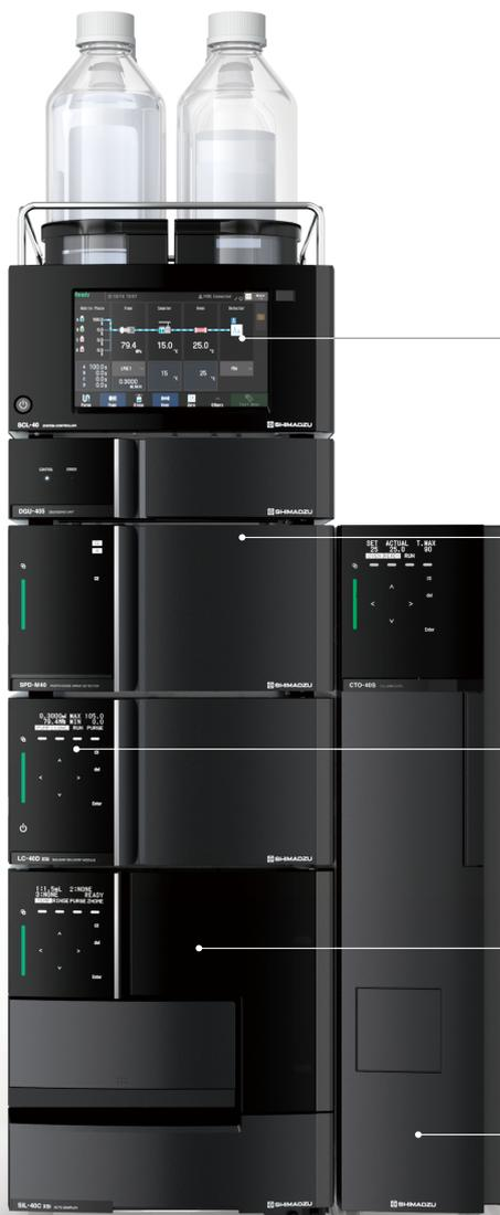
Nexera XS inert独自の技術で、すべての移動相/試料通過流路の表面における金属イオンの露出を極限まで抑えました。金属イオン由来の吸着現象の抑制と共に、分離改善を目的とした高濃度の酸や塩を含む移動相の使用においても優れた耐久性を発揮し、分析条件を選びません。
