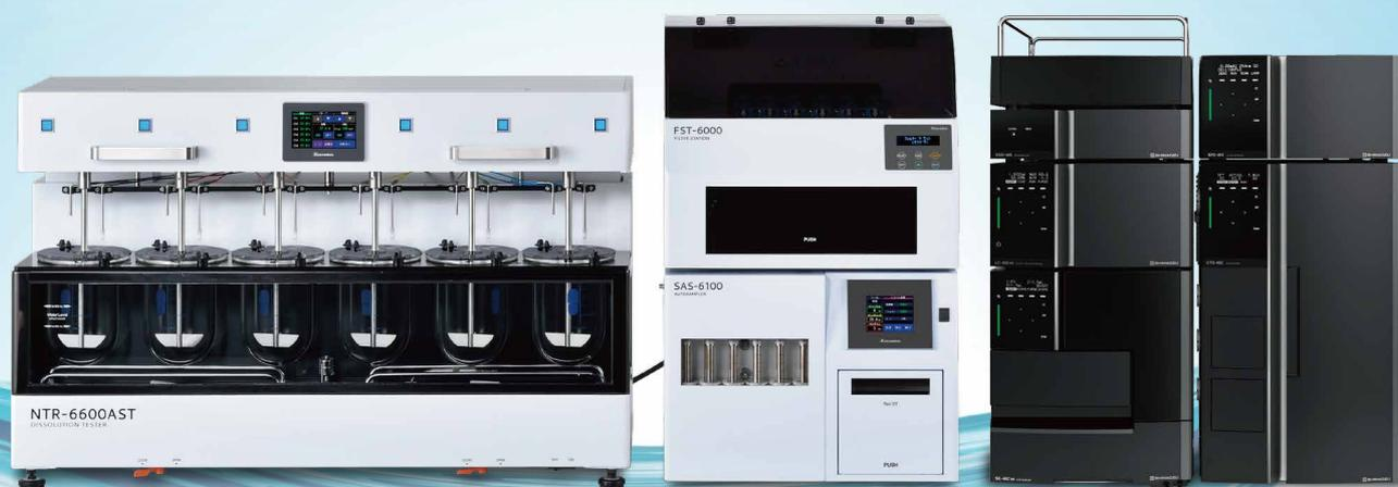
※溶出試験器とNexera FVの間は、20 cmのトレイを載せるスペースが必要です
