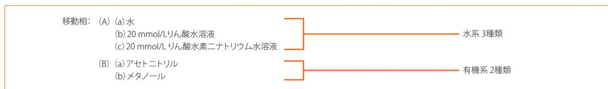
送液ユニットAに水、りん酸水溶液およびりん酸二水素ナトリウム水溶液をそれぞれセットし、混合比率を変えることでpHや塩濃度を自在に調整することができます。
