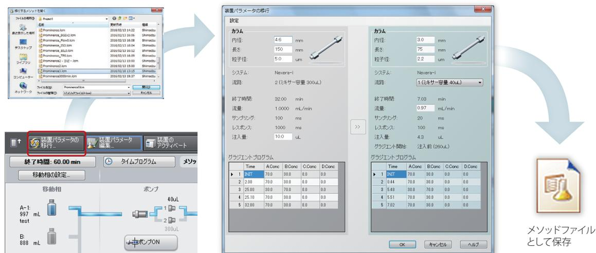
i-Seriesメソッドトランスファースystemは、HPLCとUHPLCの遅れ容量に合わせた2流路を持ち、HPLCを用いたお客様のメソッド移管を容易にすると共に、お客様のメソッドをUHPLCで高速化する検討作業を1台でスムーズに行えます。
