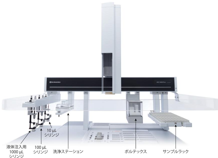
空バイアル、標準試料、内部標準物質、プロテクタント、検査試料をサンプルラックにセットし、バッチテーブルを開始するだけで、検査資料の定量を自動で行えます。
