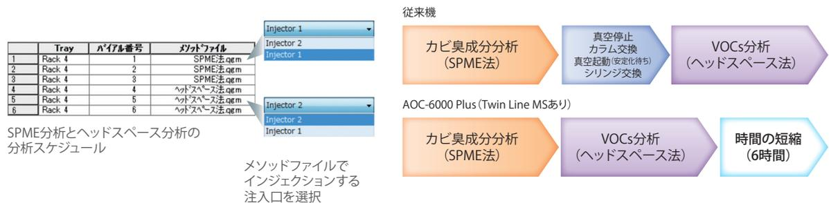
※1 Twin Line MSシステム: 2本の異なるカラムの出口側をMSに同時に取り付けすることで、MSの真空を停止することなく異なるカラムでのアプリケーションデータ採取が可能です。
