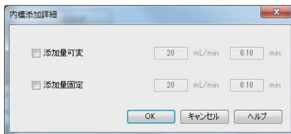
添加方法は、マスフローコントローラーを利用した添加量可変モードと、保温されたサンプルループを用いた添加量固定モードから選択できます。
