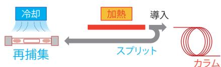
加熱脱離システムではサンプルチューブを加熱し、トラップに凝縮したサンプルを急速加熱することで、よりシャープなピークを得ることができます。さらにTD-30Rに搭載のレストア機能は、GC-MSに導入する際にスプリットした試料を無駄なく再捕集します。
