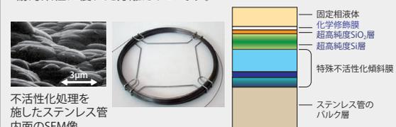
不活性化処理を施したステンレス管内面のSEM像
