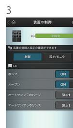
3 装置の運転を開始します。オートサンプラのリンスやリンス液のバッチの実行も可能です。
