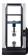
精密万能試験機 AGX-Vシリーズ *引張/圧縮/突き刺し試験に使用
