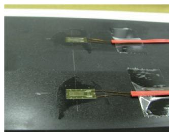
大型構造体の強度設計を行う場合、局所的に部材がどのような強度特性を有しているかを実測することが重要です。リブ非補強部①と補強部②にひずみゲージをはり各々変形量を比較しました。
