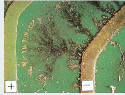
プリント基板パターン間のCuマイグレーション
