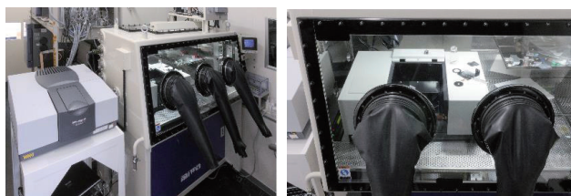
グローブボックス対応FTIR グローブボックス内に設置された第二試料室
