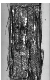
CFRPの高速引張試験
