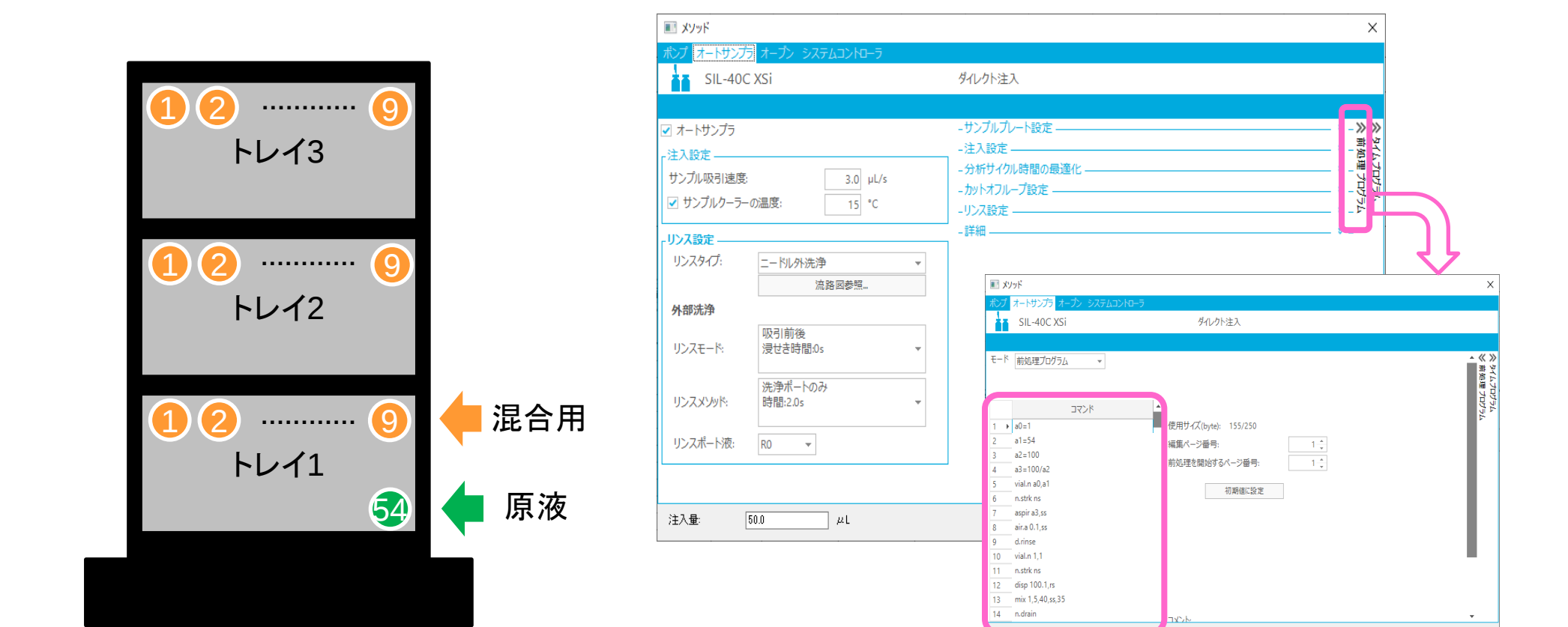
図3 オートサンプラーのラック模式図 原液バイアル:トレイ番号1、バイアル番号54
