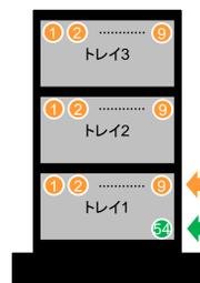
図3 オートサンプラーのラックモード図(原液バイアル:トレイ番号1、バイアル番号54)
