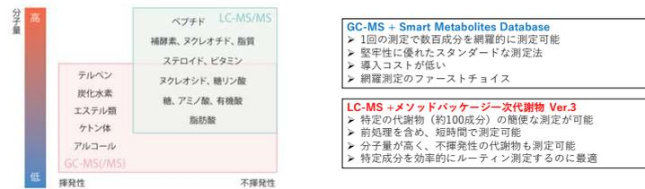
図4 メタボロミクスに適した測定機器
