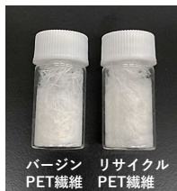
図2 バージンPET繊維 (左)とリサイクルPET繊維 (右)の試料
