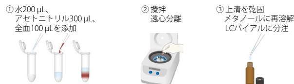
図2 Micro Volume QuEChERS kitを用いた前処理フロー
