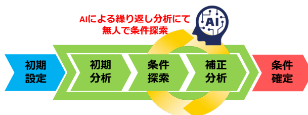
図1 LabSolutions MDのグラジエント条件自動最適化のワークフロー
