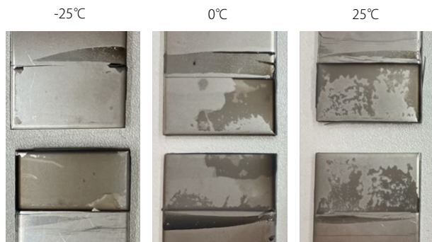
図5 TB2049/2149 破断面の様子
