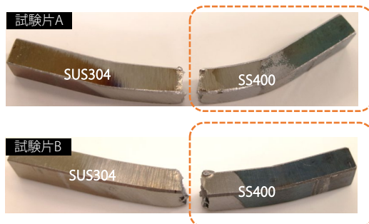
図6 疲労試験後の試験片AおよびB
