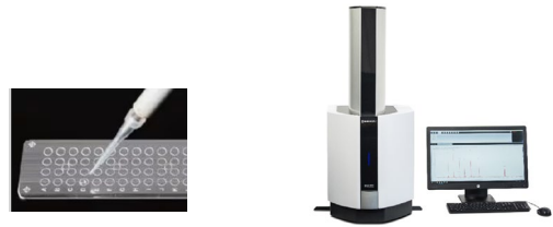
図3 左：MALDIプレートへのアプライ 右：卓上型MALDI-TOF MS MALDI-8030
