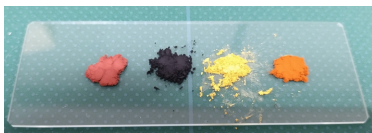
図2 試料の外観 左からFe 2 O 3 、Fe 3 O 4 、α-FeO(OH)、γ-FeO(OH)
