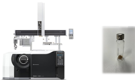
図1 GCMS-TQ™8040 NX (左) と煙草の葉試料 (右)
