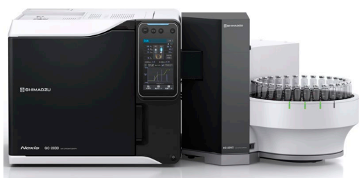
図1 Nexis™ GC-2030とヘッドスペースサンプラーHS-20 NX
