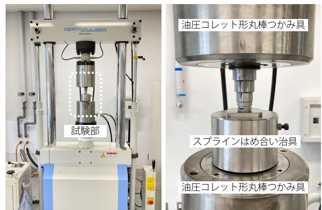
図2 試験の様子 (左: 試験機全体、右: 試験部)
