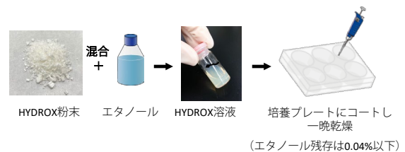
図2 HYDROXプレートの作製方法
