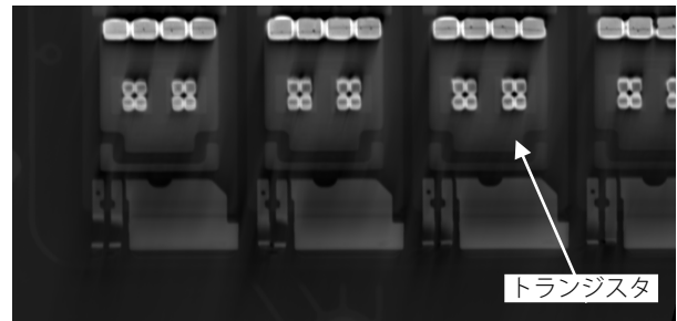
図3 トランジスタの断面画像
