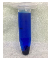
遠心分離後の色素吸着したCNF水懸濁液
