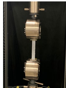
図3 FRP用定位置くさび形つかみ具
