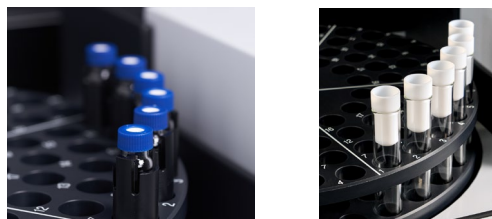
図2 ATLAS-LEXT NHDに1.5mLバイアルをセットした様子（左図） 溶媒抽出中にサンプルバイアルキャップを使用した様子（右図）
