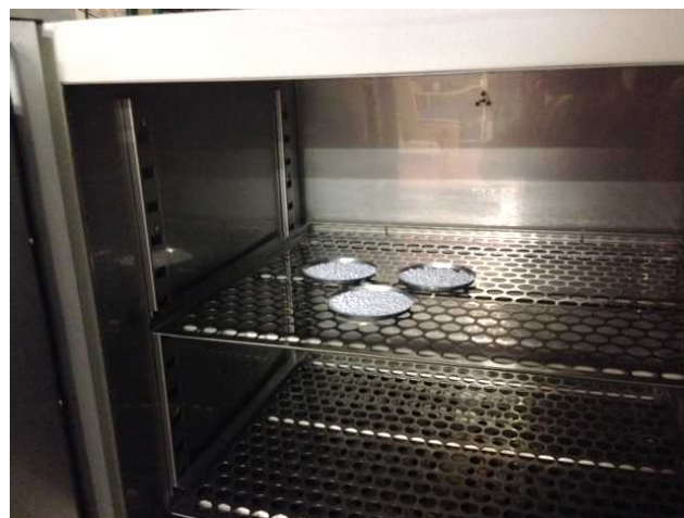
Fig.1 樹脂ペレットを恒温槽へ入れる前の状態
