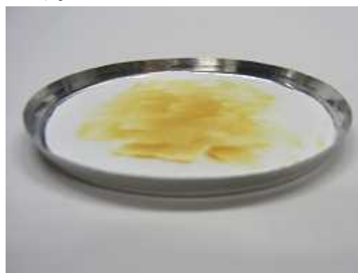
(測定後) 水分・油脂分が蒸発し、多少変色していますが、データとしては問題ありません。
