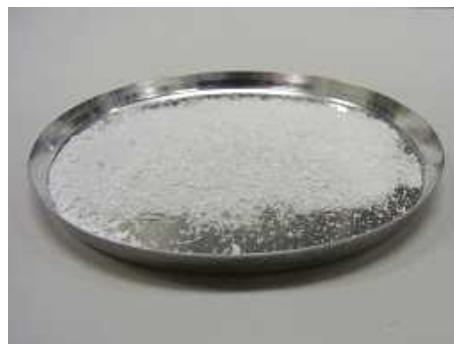
(測定後) 水分子が分離し白く変色しています。
