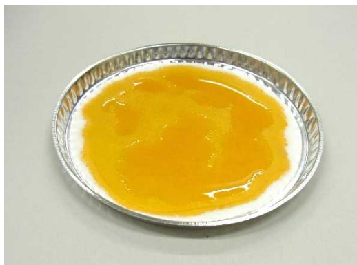
(測定前) 使い捨てのアルミ皿にグラスファイバーを載せパーム油を滴下しました。
