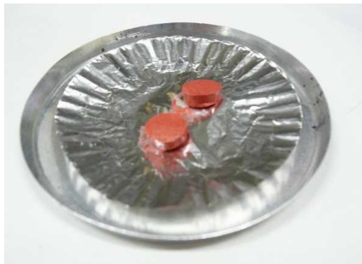
(測定前) 口紅を約3mm厚に輪切りにし、皿の上に載せたアルミ箔の中央付近に置きました。
