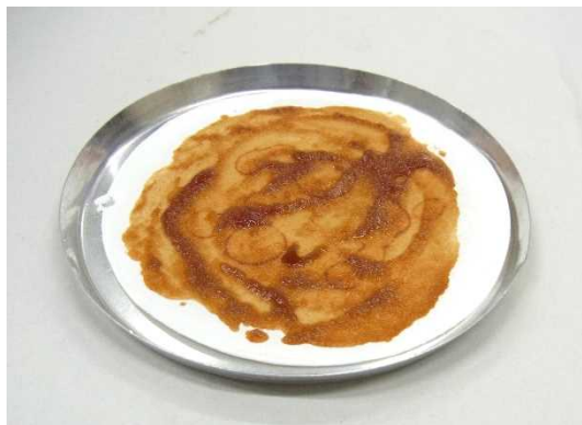
(測定前) トマトケチャップをグラスファイバーシートに垂らし、ヘラで伸ばしました。
