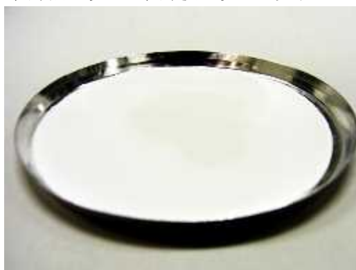
(測定前) 液体測定用グラスファイバーシートに牛乳1gを滴下しました。
