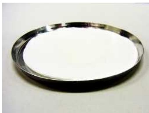
(測定後) 牛乳の水分が蒸発し、残った脂肪分がわずかに黄色く変色しています。
