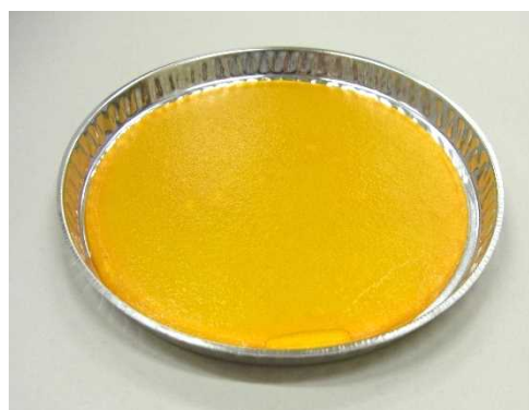
(測定後) パーム油が全体に広がっています。外観はほとんど変化が見られません。
