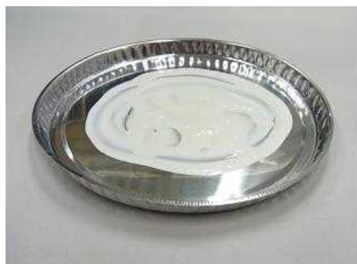
(測定後) 塗料の厚い部分に液体が沸騰した後が見えますが、焦げた様子はありません。
