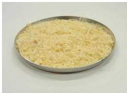
(測定後) 中央付近の表面が茶色くなって焦げて いますが、水分率の繰返し性は良好です。
