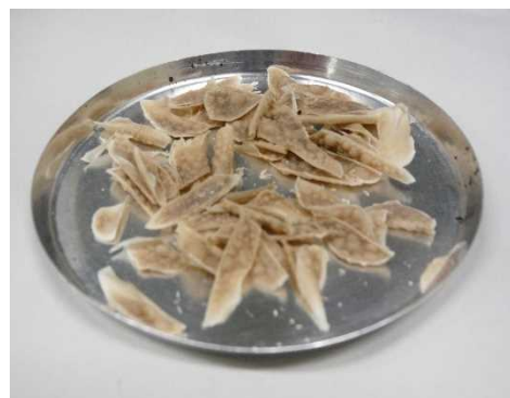
(測定後) 全体が褐色に変化し、表面に気泡が発生しています。
