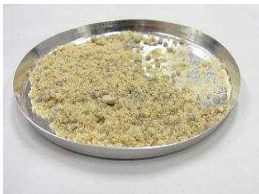
(測定前) 試料を皿に均一に広げました。一部生豆の塊が存在します。
