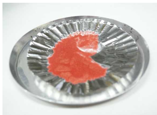
(測定後) 約1分後に口紅が溶けはじめました。室温に戻しますと粘度と感触は最初とほとんど変わりませんでした。
