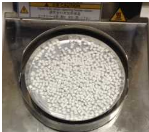
Fig.2 MOC63u に樹脂ペレットを載せ、乾燥終了後の状態
