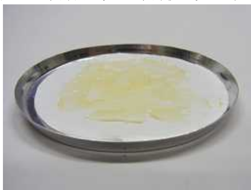
(測定前) 液体用グラスファイバーに試料をとり、へらで均一に広げました。
