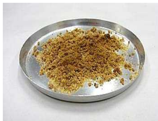
(測定後) 一部表面が茶色くなって焦げていますが、水分率の繰返し性は良好です。
