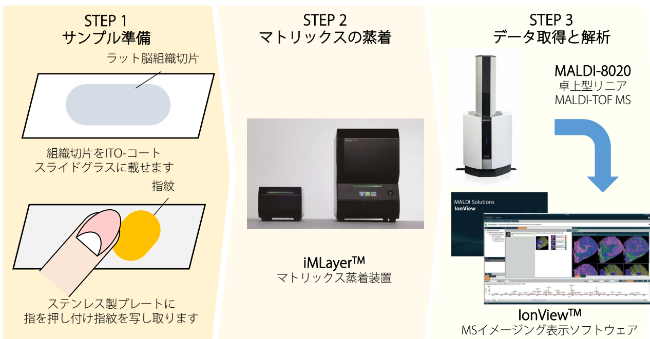
図1 MALDI-8020 を用いたMSイメージングのワークフロー
