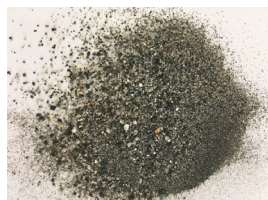
図2 路肩の堆積物
