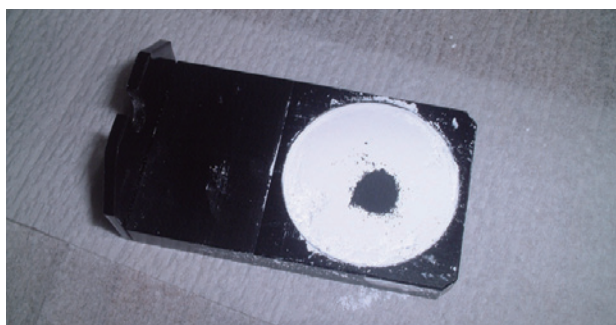
Fig. 1 硫酸バリウム上に試料を盛った状態 Sample Put on \text{BaSO}_4 Powders
