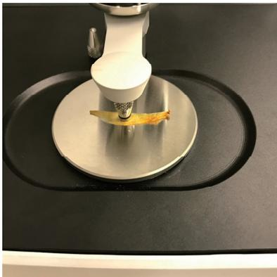
図 5 ATR 法による骨片試料の測定の様子
