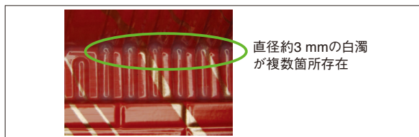
Fig. 1 食品トレー白濁部の写真 Photograph of White Parts on Food Tray
