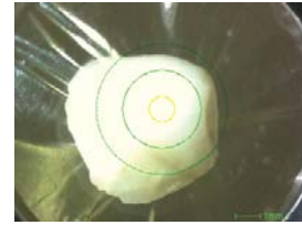
図1 異物の写真 (黄色枠がX線照射範囲: 1 mmΦ)
