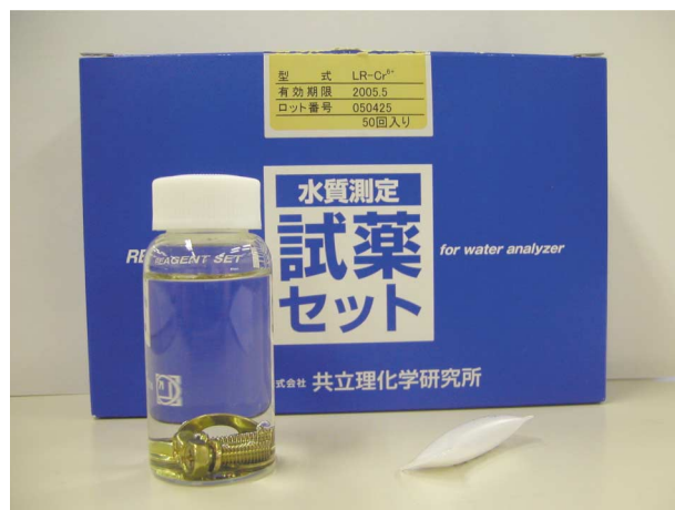
Fig.1 熱水に浸漬したサンプルおよびジフェニルカルバジドパックド試薬 Sample in hot water and Packed-Reagent
