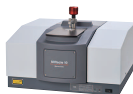
Fig. 2 1回反射型全反射測定装置 MIRacle10 を装着した IRAffinity-1 の外観 Overview of IRAffinity-1 Attached MIRacle 10 ATR Accessory
