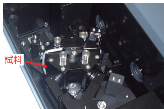
Fig. 2 積分球に試料を設置した状態 Sample Set in Integrating Sphere
