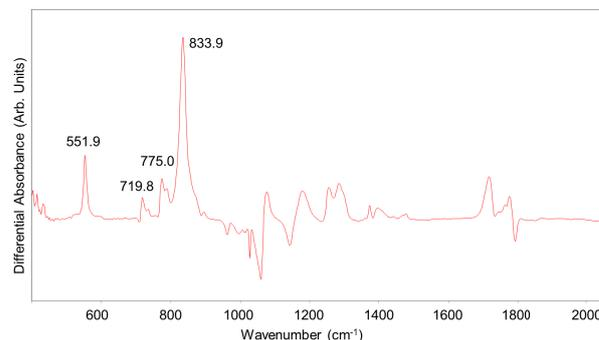
図7 1M LiPF<sub>6</sub>を含むEC+DEC（3：7）電解液と
