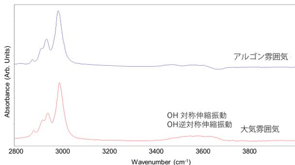
図5 1M LiPF<sub>6</sub>を含むEC+DEC（3：7）電解液の赤外スペクトル
