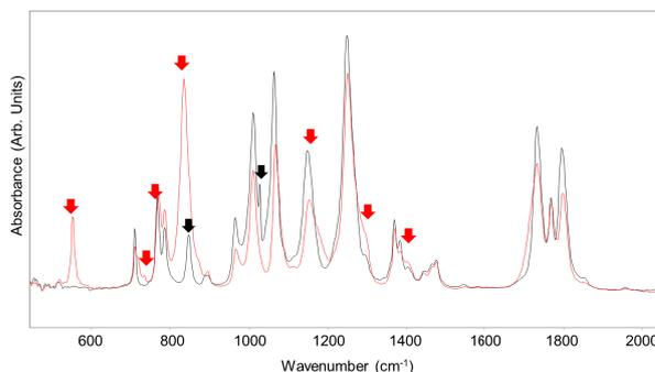
図6 1M LiPF<sub>6</sub>を含むEC+DEC（3：7）電解液（赤）と
