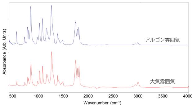
図4 1M LiPF<sub>6</sub>を含むEC+DEC（3：7）電解液の赤外スペクトル
