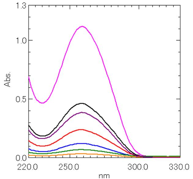
図5 Nano Stick を用いた場合の Lambda-DNA の吸収スペクトル
