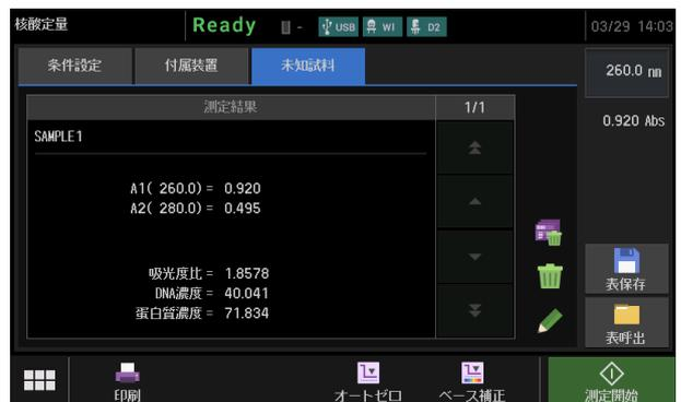
図6 核酸定量の測定結果画面
