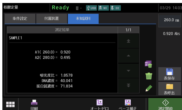
図6 核酸定量の測定結果画面
