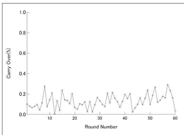
Fig.4 核酸定量における自動ワイピング性能
