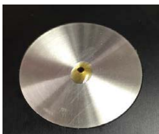
図2 プリズムプレートの拡大図（エンジンオイルを滴下した状態）
