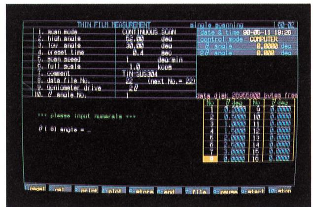
Fig.2 薄膜測定条件の入力画面
