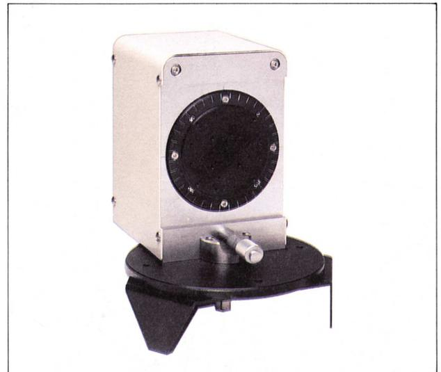
Fig.1 薄膜測定装置試料ホルダー
