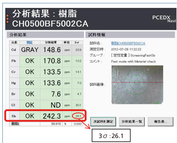
Fig. 6 樹脂片のスクリーニング分析・判定結果画面 Window of Screening Result of Plastic Piece
