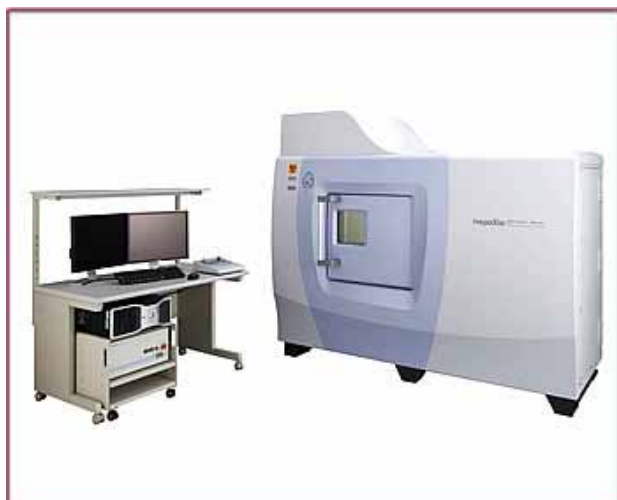
Fig.1 マイクロフォーカスX線CTシステム inspeXio SMX-225CT 外観 Overview of Micro-focus X-ray CT system
