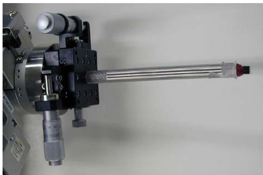
Fig.3 VCTユニットへの供試体取り付け状態 The Specimen mounted on the VCT unit
