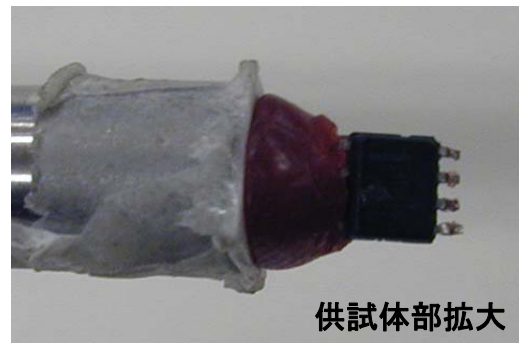
Fig.3 VCTユニットへの供試体取り付け状態 The Specimen mounted on the VCT unit
